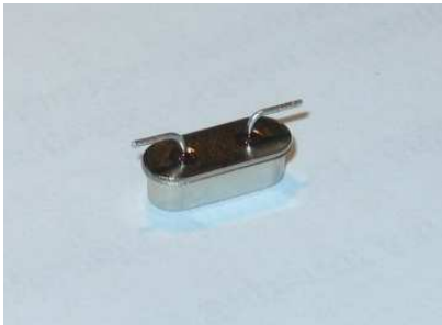
Kuva 7. Kiteen jalat taivutettu
