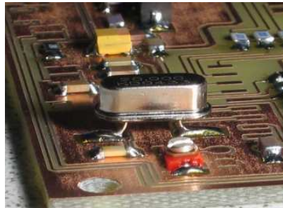
Kuva 8. Kide juotettu SMD:n tavoin
